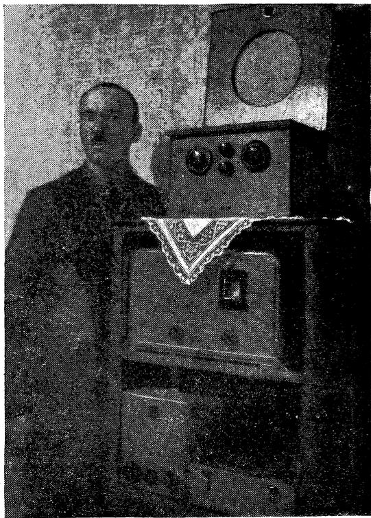
Рис. 7. Тов. Сурменев у своего телеоборудования. Наверху репродуктор и приемник для звука. На средней полке ЭЧС-3. Внизу телевизор и электропатфон.
